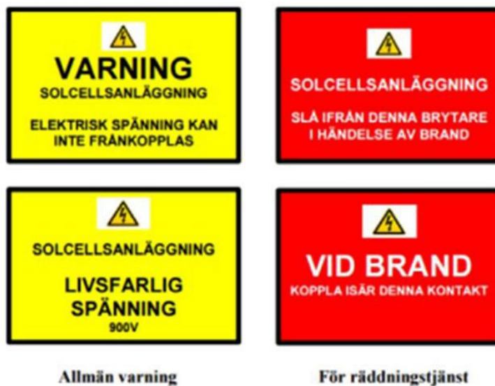
Figur 4 Exempel på skyltning för spänningsförande delar och brytare (MSB)
