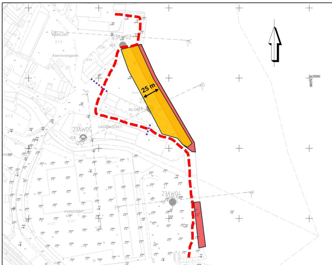
Figur 7-2 - Utdömda kajkonstruktioner (rött) och riskområde för skred (orange) som bör spärras av innan stabilitetsförhöjande åtgärder utförs.
