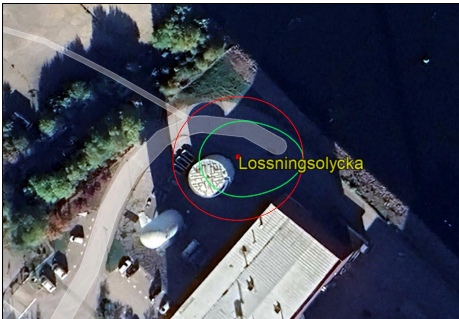
Figur 2.2 Avståndet till 15 kW/m 2 från lossningsolycka till grön kontur är maximalt 21 m. Radien av röd kontur är 21 m och visar avståndet till 15 kW/m 2 oberoende av vindriktning.
