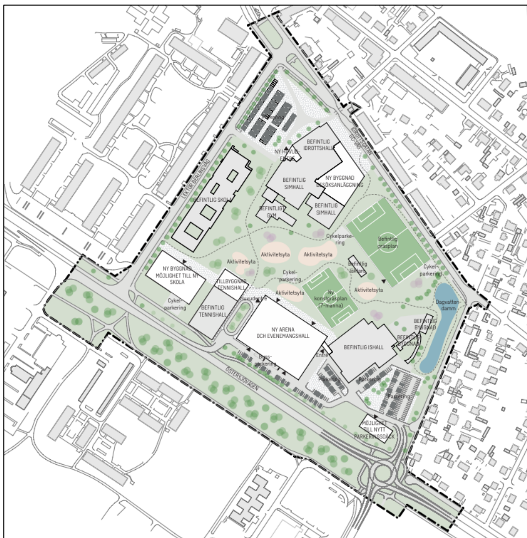
Figur 10: Illustrationsplan (Sweco, 2023-01-16) med föreslagen dagvattendamm (ljusblå).
