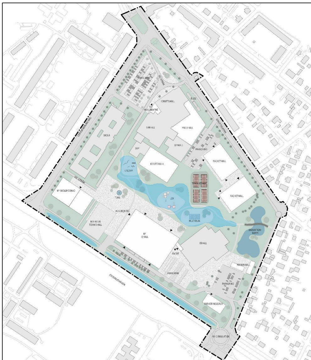
Figur 15: Föreslagna fördröjningsytor för skyfallsregn markerade i ljusblått.
