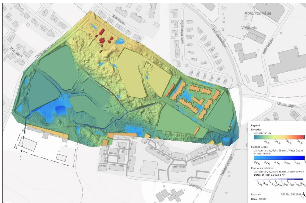
Figur 14 .Dagvattenlösningar för detaljplanen med 100 års regn med varaktighet 35 minuter motsvarande 58 mm regn. Kvartersmark höjs till rekommenderade nivå. Skyfallssåtgärder tillskapas för nya kvarter och allmänplatsmark.
