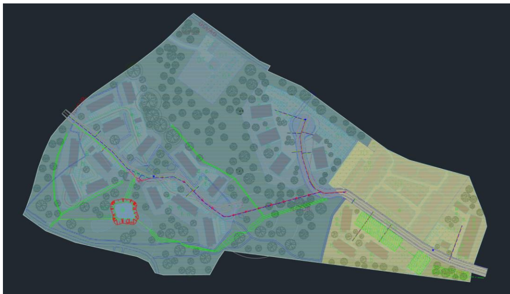
Figur 13 Delavrinningsområden (färgmarkerat) inom utredningsområdet baserat på områdets topografi. Västra delavrinningsområdet (7,49 ha) markeras med blått. Östra avrinningsområdet (2,21 ha) markeras med orange.
