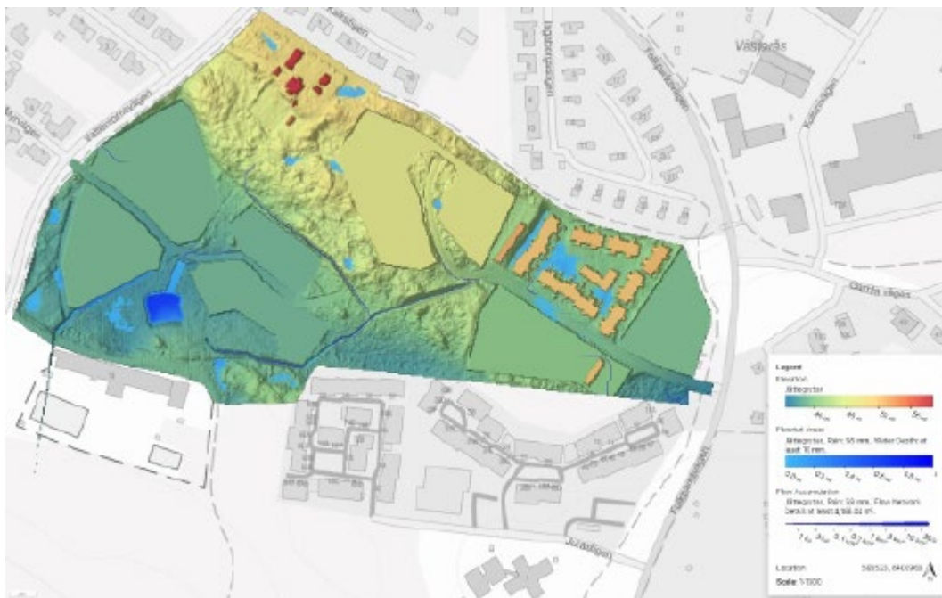
FIGUR 29: Dagvattenlösningar för detaljplanen med 100 års regn med varaktighet 35 minuter motsvarande 58 mm regn. Kvartermark höjs till rekommenderade nivå. Skyfallssåtgärder tillskapas för nya kvarter och allmänplatsmark. Bild från genomförd förprojektering.
