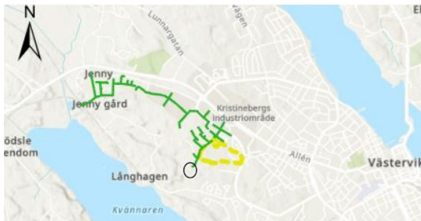
FIGUR 27: Dagvattennät som tidigare utretts med påvisade risker för dämning. Markerat utlopp redovisat som svart cirkel på kartan har varit föremål för studerad dämningrisk i utloppsläge vid Vattentornsvägen.
