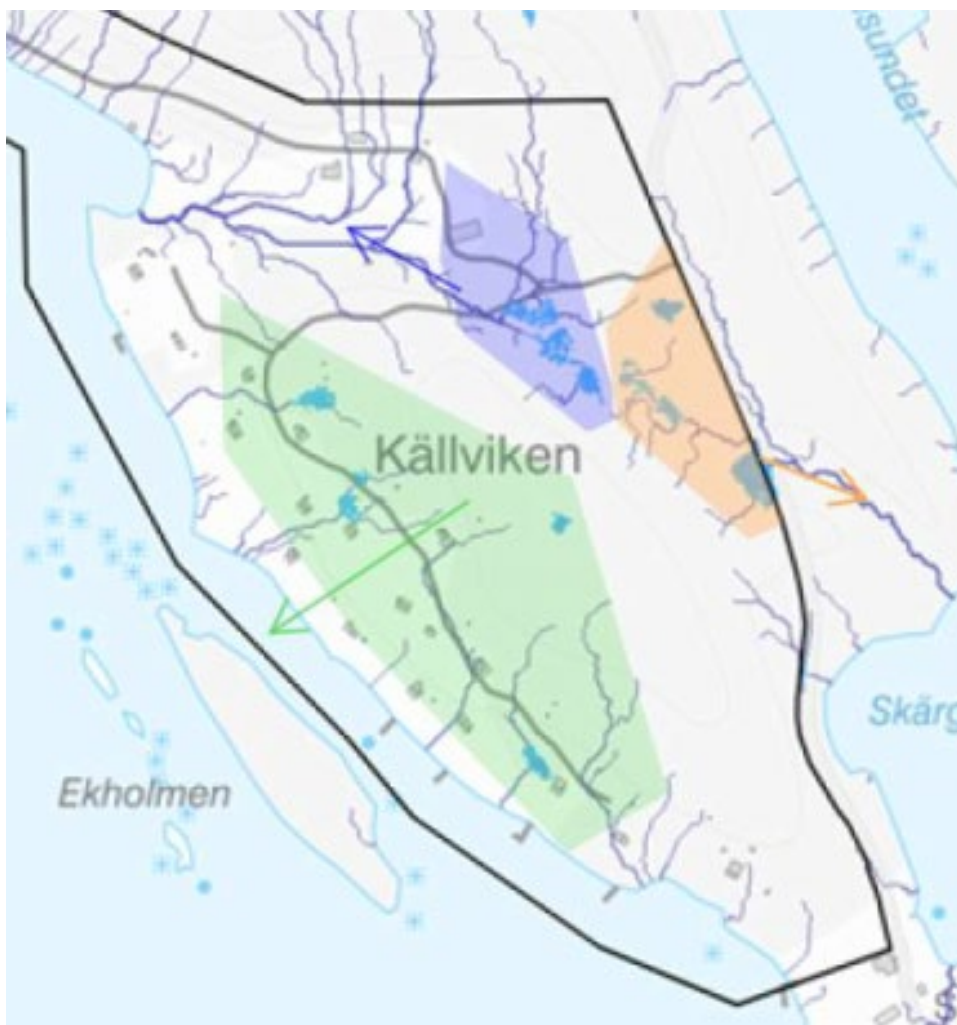
Figur 4: Områden där vatten samlas vid 68 mm regn, vilket motsvarar ett 100-årsregn, är markerade i ljusblått. Pilarna visar huvudsaklig flödesriktning från respektive delområde. (Scalgo Live 2022)
