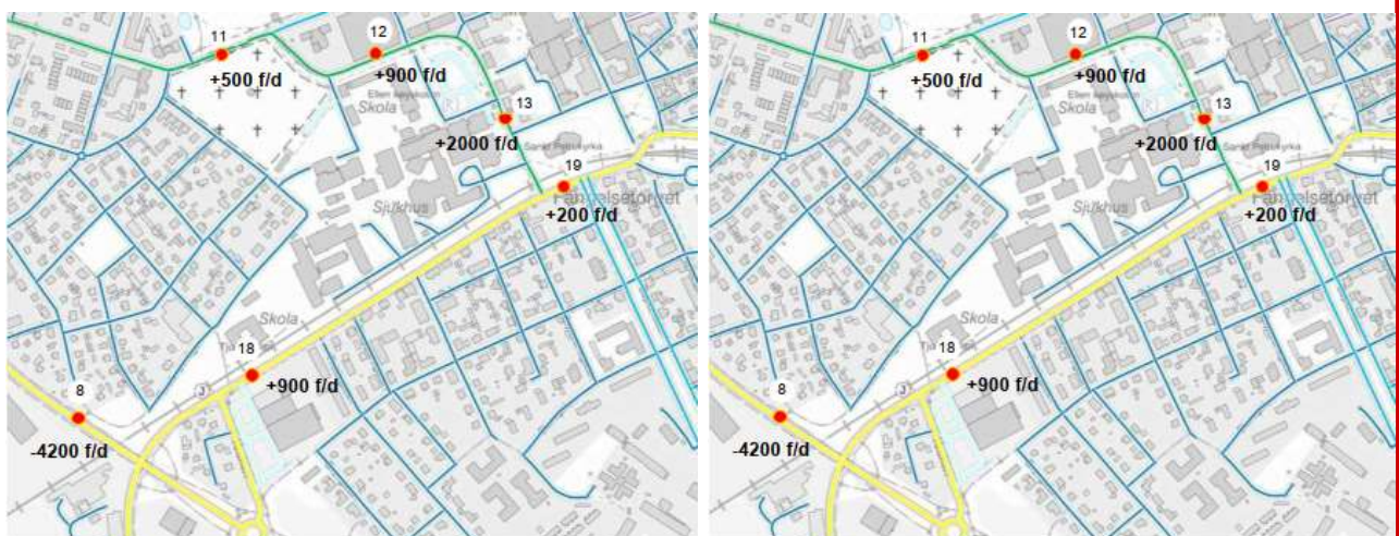
Figur 46 och 47 Förändring av förväntade trafikflöden omkring sjukhuset år 2040, utan respektive med ny södra infart
