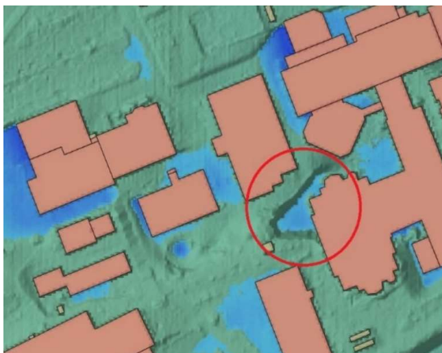
Figur 38. Inneslutet lågmarkszon, nordväst om Hus 20
