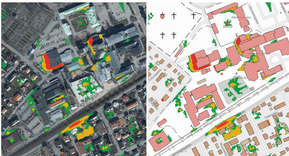
Figur 24 och 25. Datasimulering i programmet Scalgo vid skyfall med 50 mm vattenmängd. Röda områden anger vattendjup över 30 cm, gula områden 10–30 cm och gröna områden upp till 10 cm. Bsv arkitekter & ingenjörer ab, 2023.
