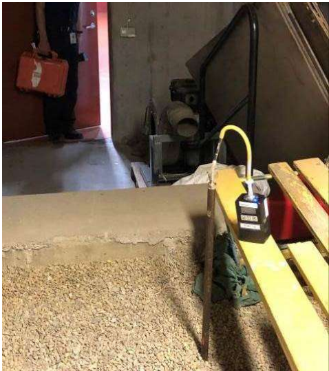
Porgasmätning vid M (underkulvert)
