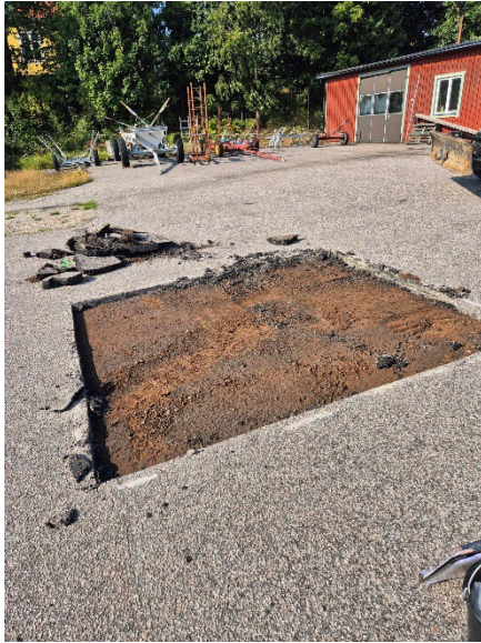
Figur 4. PG 11. Bärlager under asfalt. Halter över KM påvisades i ett av tre prover.
